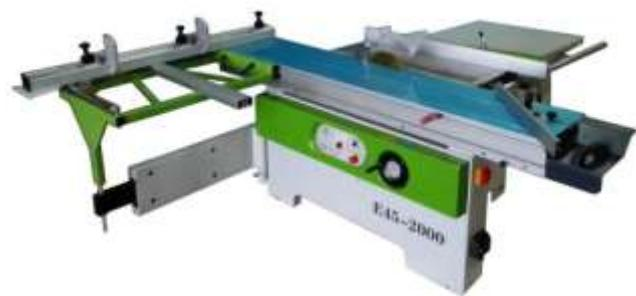
Форматно-раскроечный станок с наклоняемой пилой и подвижной кареткой на роликовых направляющих. Предназначен для штучного и пакетного раскроя плитных материалов, в т.ч. облицованных ламинатом. Станок спроектирован для использования в тяжелых условиях работы, отлично зарекомендовал себя в условиях крупносерийного и массового производства. Применяется в серийном мебельном и столярном производствах для изготовления корпусной мебели.
