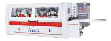
Станок четырехсторонний 6-ти шпиндельный модели HJD-M623A используется для одновременной продольной обработки с четырех сторон деталей и заготовок большого сечения (до 150 х230 мм), произведенных из цельной древесины хвойных и лиственных пород, с целью выпуска разнообразных погонажных материалов (наличников, багета и т.п.), бруса различного профиля и других изделий из древесины.
