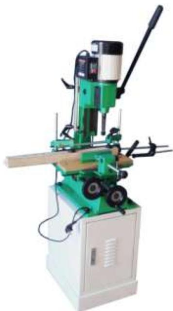
Сверлильно-пазовальный станок MS3840 предназначен для создания прямоугольных пазов, канавок, гнезд разной сложности в деревянных заготовках.
